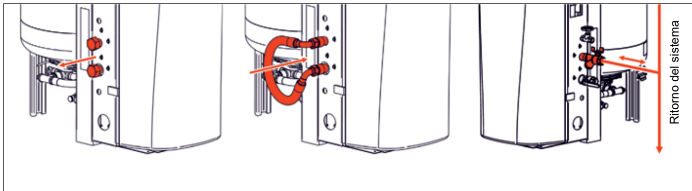
Immagine 14: Collegamento dei raccordi con il set di bypass e collegamento al ritorno del sistema
