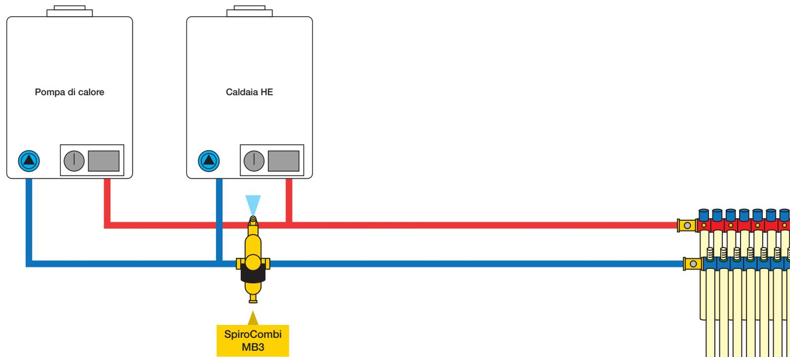
Schema - Sistema ibrido a pompa di calore con SpiroCombi MB3
